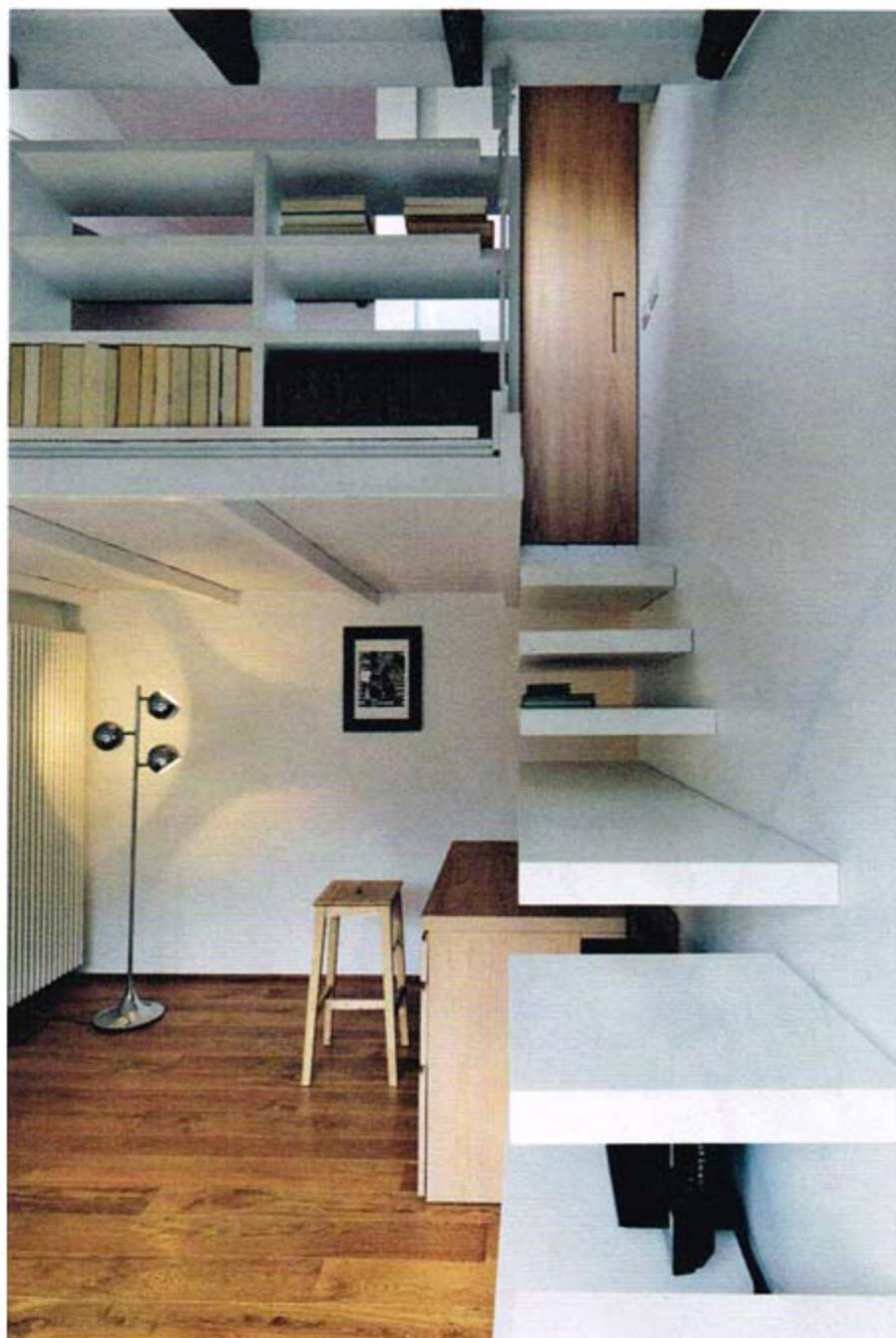
**1.** Il soggiorno è arredato con il divano che fronteggia l'originale struttura scala-libreria che sale al soppalco. La struttura portante del soppalco, in acciaio e doghe di abete massiccio, è ancorata al soffitto tramite tiranti d'acciaio.
